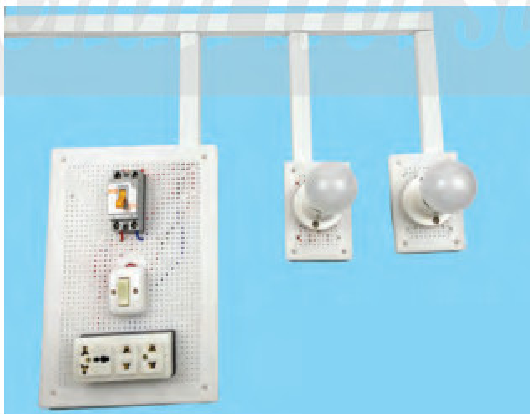
Hình 6.8. Mô hình mạch điện điều khiển hai bóng đèn sáng luân phiên
