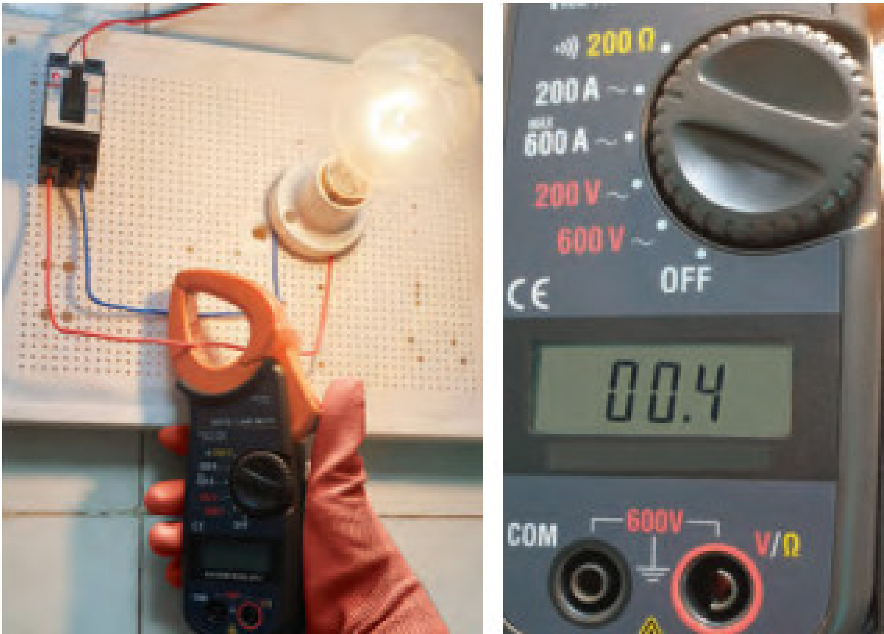
Hình 2.5. Sử dụng ampe kìm đo cường độ dòng điện xoay chiều
